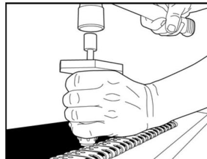
8. Используя молоток 0,9 кг, установите заклепки сначала в центральное звено полосы соединителей, затем в крайние звенья. Установите заклепки в оставшиеся звенья соединителей.
