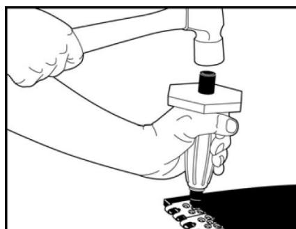
10. Переверните ленту и поместите на твердой поверхности. Установите заклепки используя молоток 0,9 кг и приспособление R5S. Поверхность ленты должна всучиться вокруг кромки соединителей.
