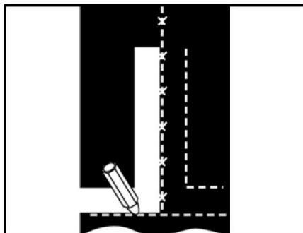
1. Отметьте перпендикулярную линию отреза ленты используя метод центральной линии. Используйте резак Flexco для получения прямой линии отреза
