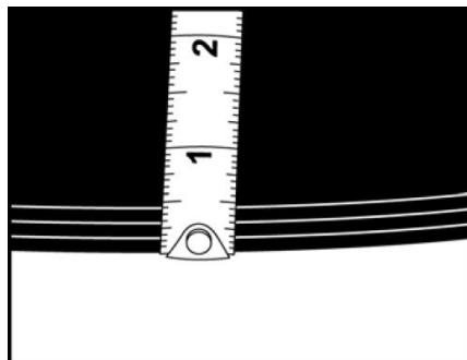
2. Измерьте толщину транспортерной ленты. Выберите надлежащий размер заклепок SR, соответствующий толщине ленты..
