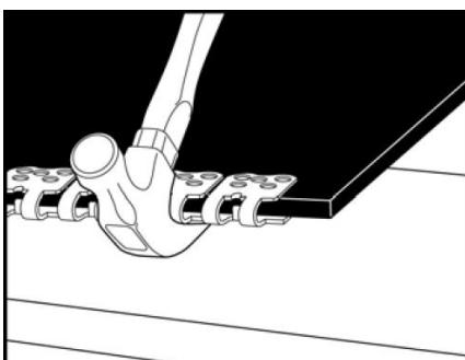
9. Удалите штыри, фиксирующие ленту. Поднимите ленту с деревянной основы. Пилотные фиксаторы должны остаться на месте.
