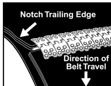
11. Повторите шаги 1-10 с другим краем ленты. Соедините края ленты вместе и вставьте шарнирный стержень. Край ленты по ходу движения с обеих сторон обрезают под небольшим углом по длине 7,5- 8 см, для того чтобы лента не задевала за ролики. Соединение выполнено.
